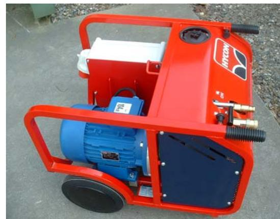
HYCON HPP18E оснащена мощным 11 кВт двигателем.
